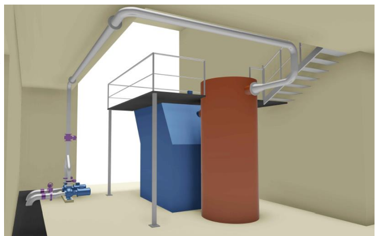
Abbildung 23: Lamellenklärer (links); Visualisierung Projekt Flockungsreaktor mit Lamellenklärer (rechts) [Wabag]
